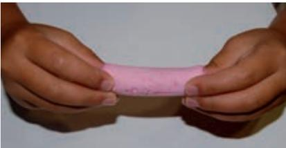
La nube que observas en las fotografías se deforma fácilmente cuando se aplica una fuerza sobre ella porque es de un material deformable. Sin embargo, en una estructura de materiales más rígidos la deformación no es tan apreciable. Para saber a qué tipo de esfuerzo está sometida dicha estructura, hay que imaginar la deformación que se produciría si fuese de un material más moldeable.
