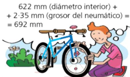
Alberto calibra el cuentakilómetros de su bici a fin de medir de la forma más exacta posible la longitud de sus trayectos. Para ello, calcula la longitud de la rueda:  $L = \pi \cdot d = \pi \cdot 0,692 \text{ m} = 2,1739821... \text{ m}$
